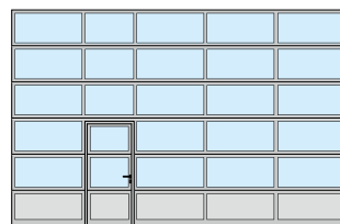
uspořádání integrovaných dveří vlevo
