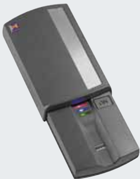
Rádiový snímač otisků prstů FFL 12 BS Pro 2 funkce a až 12 otisků prstů
